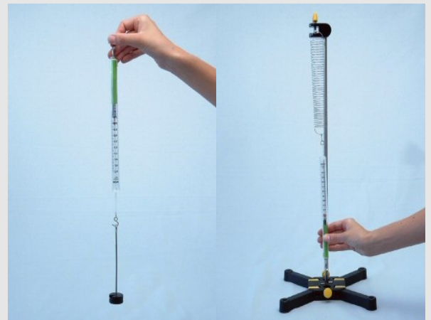
Levantar una masa y estirar un resorte, cada uno con la ayuda de un medidor de fuerza
